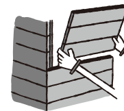
サイディング仕上り工事
